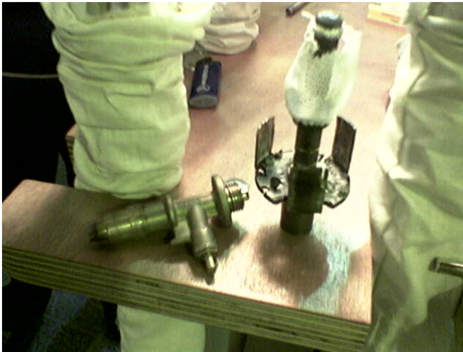
Imagen 7. Componentes del hachote de butano: Regulador, inyector, quemador y camisa.
