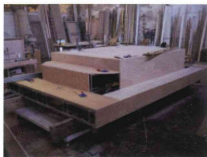
Imagen 3.- Vista del bastidor forrado con tablero fenólico.
