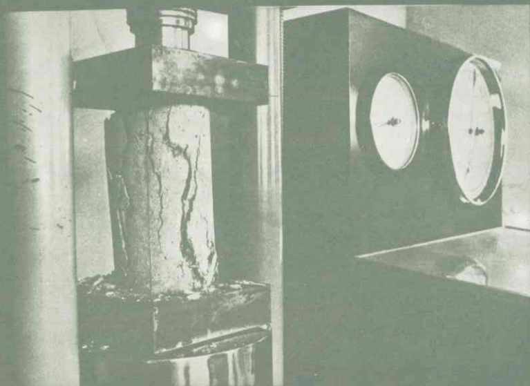
Un bloque de hormigón que se rompe tras serle aplicada paulatinamente una presión de 62.000 Kg.
